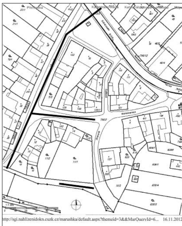
Obr. 129. Uherské Hradiště (k. ú. Sady), ulice Vřesová, Malostranská. Oprava kanalizace (stoka BVII-1a, BVII-1a-1), říjen – listopad 2012. Poloha liniových výkopů.
